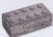
Foto 6: Příklad hmatových úprav z betonových dlažebních bloků se speciální povrchovou úpravou - pravidelné výstupky: - oddělení cyklistické stezky od pruhu pro pěší (0,3 - 0,4 m, barevně kontrastní) - signální pás (0,8 m, barevně nektrastní) - varovný pás (0,4 m, barevně kontrastní)
