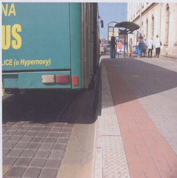
Foto 9: Příklad řešení zastávky veřejné hromadné dopravy s bezbariérovým obrubníkem
